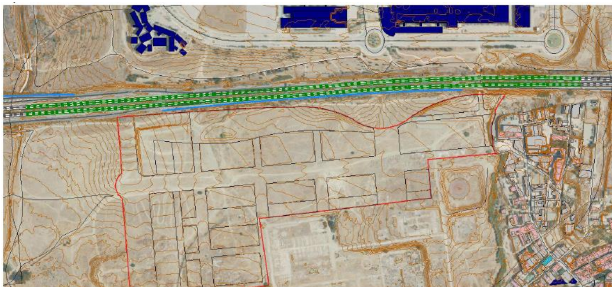
Figura 28: Asfalto fonorreductor propuesto (planta) (Acción 2)
