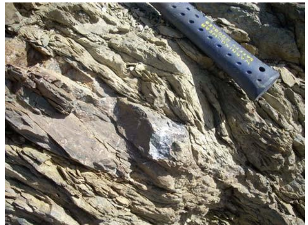
Imagen nº 12: Detalle de zona de fractura en esquistos con capas de arenisca aboudinadas.
