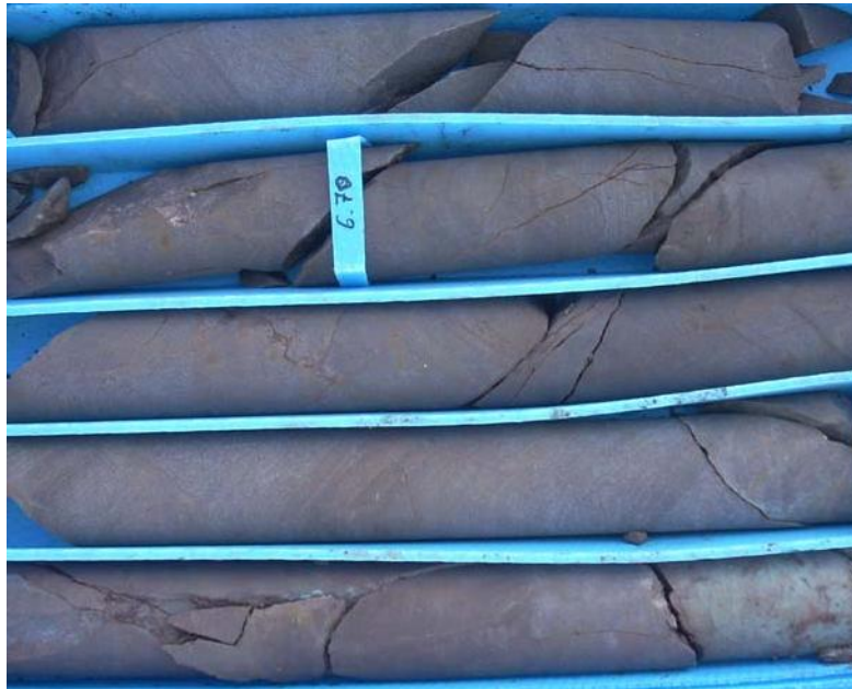
Imagen nº 29: Aspecto en sondeo de las facies areniscosas del Permotrías.
