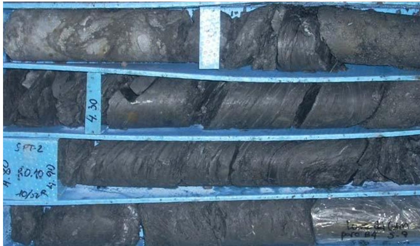
Imagen nº 10: Aspecto en sondeo de los esquistos negros del Carbonífero.
