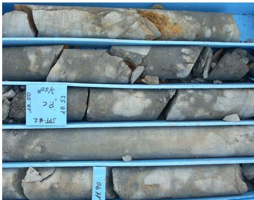
Imagen nº 5: Aspecto en sondeo de las areniscas del Carbonífero.
