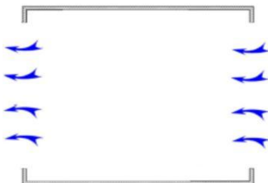
Figura 3 - Diagrama de ventilación natural
