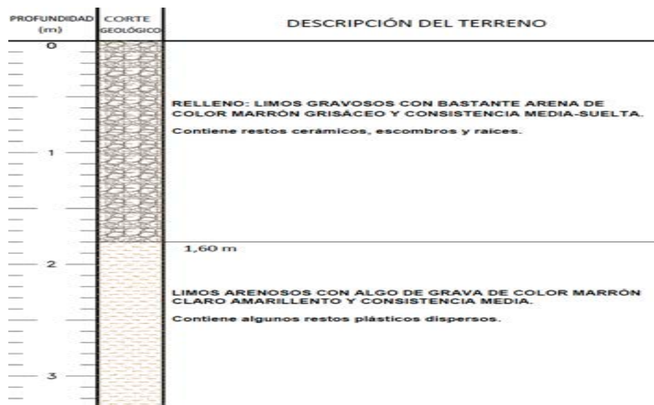
Ilustración 9: Interpretación de la geotecnia.
