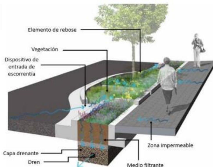
Esquema de un parterre inundable. Fuente: Adaptado de Washington DC Department of Transportation (2014).
