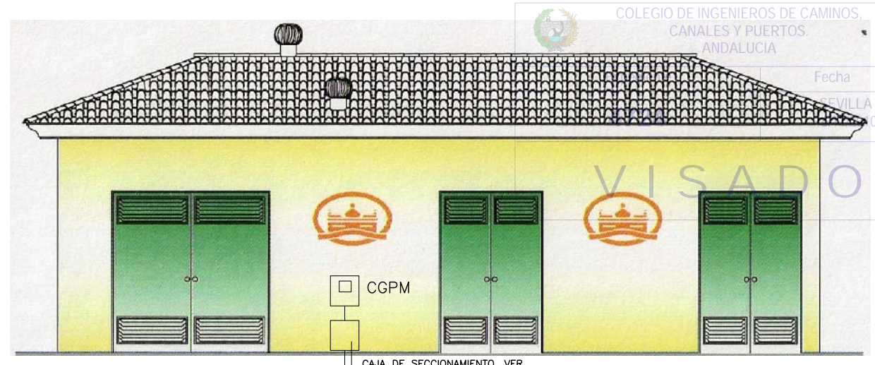
ALZADO FRONTAL DE EDIFICIO DE EBAR ESCALA 1:50
