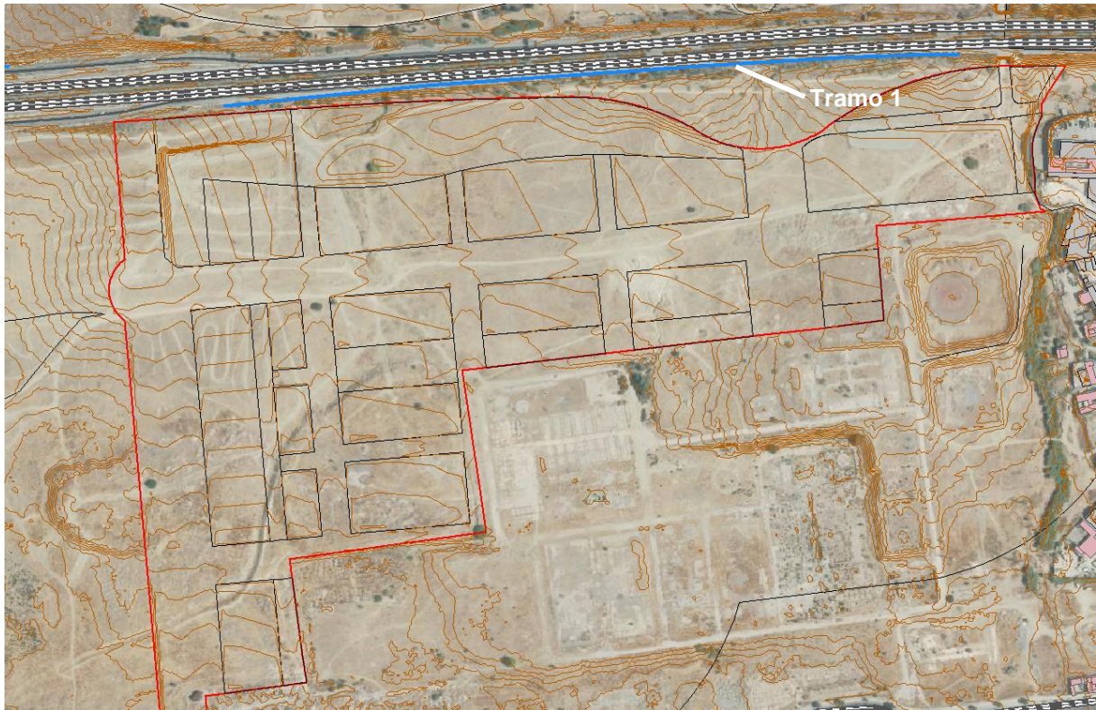
Figura 31: Pantallas acústicas propuestas (planta) (→) (Acción 1)
