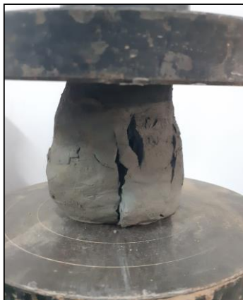
Despues de la rotura
